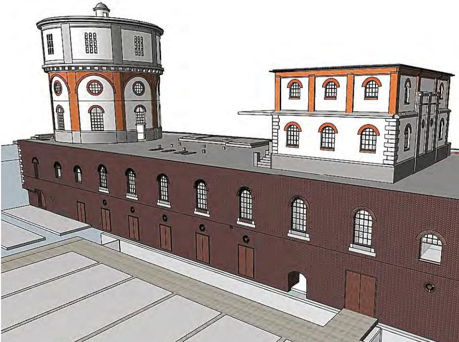
**BIM = BUILDING INFORMATION MODELING** Alle relevanten Daten zum Bauwerk werden digital modelliert und das Bauwerk kann als virtuelles Modell visualisiert und so aus allen Blickwinkeln und Perspektiven betrachtet werden. Foto: BIMm GmbH, Sontheim
